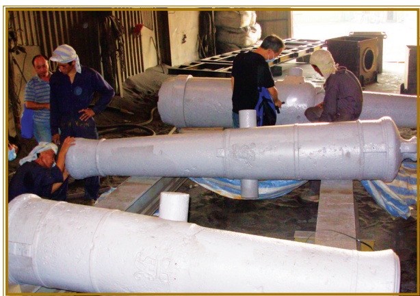
◆ 清除锈蚀物后，工人为古炮涂上保护油漆
